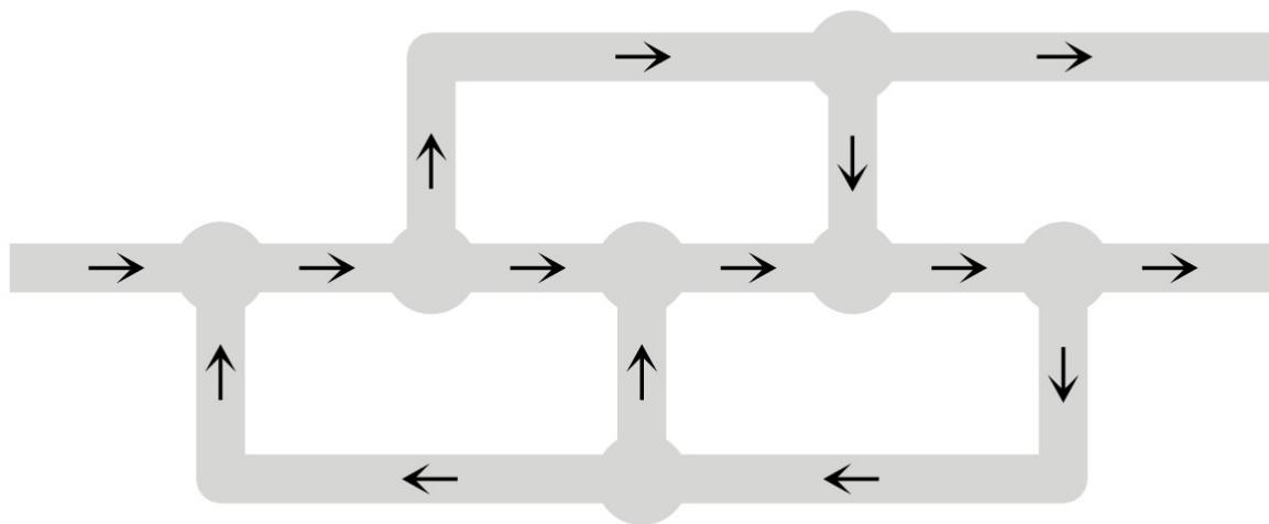
Через переплетение труб и клапанов течёт вода. Система односторонняя, вода течёт в направлении стрелок. Вода со всех входящих в клапан труб складывается вместе, а потом делится поровну между всеми исходящими из клапана трубами.
