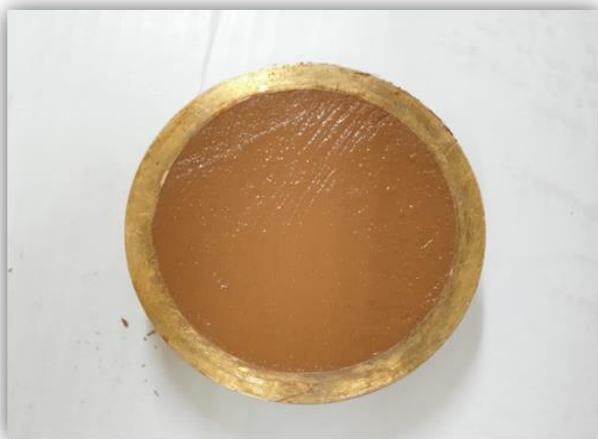
Рис. 2. Паста, на основе суспензии из ожезненной глины (840 г/л) при добавке бентонита 90 г/л
