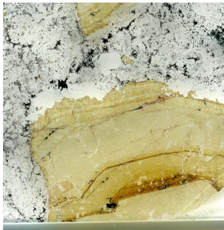
Рис. 5. As-Sb минерализация. Агрегаты рисовидного кварца с тонкоигольчатыми буланжеритом и семсейитом (чёрные) с гнёздами маложелезистого сфалерита (светло-коричневый). В проходящем свете. Поле зрения 17x17 мм
