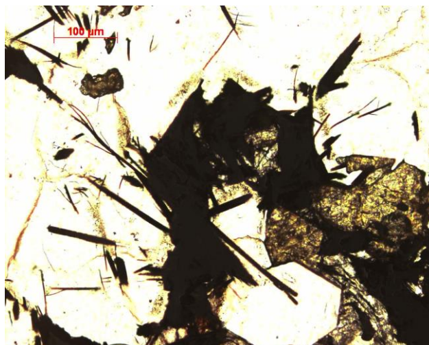
Рис. 4. As-Sb минерализация. Агрегаты рисовидного кварца, маложелезистого сфалерита (коричневый), игольчатого джемсонита. В проходящем свете при 1 николе.
