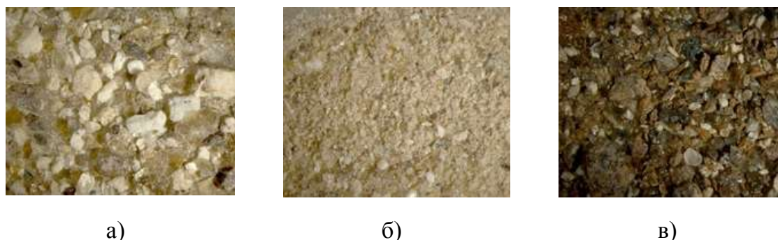
Рис. 1. Общий вид конечных продуктов обогащения, увеличение 15 х : а – зернистый продукт; б – шламовый продукт; в - «хвосты»
